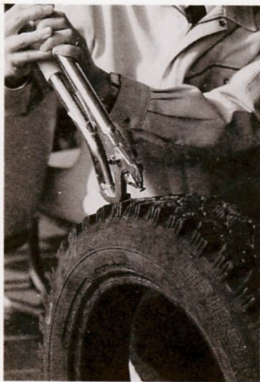
スパイクタイヤのピン抜き工具を環境課で貸し出します
