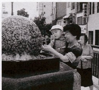
水圧で回転するフローティングボール
