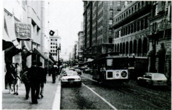
サンフランシスコのケーブルカー。街路が厳しい急傾斜なのでワイヤで引く張っている。乗車賃は1ドル
