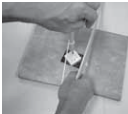
弥生人のように、弓キリ方式で穴を開けると手間と時間がかかり、とても大変です。
