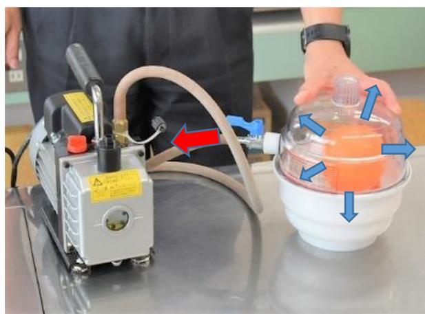
真空ポンプで容器の空気を抜くと、風船内の空気が押して風船は大きくなっていきました。
