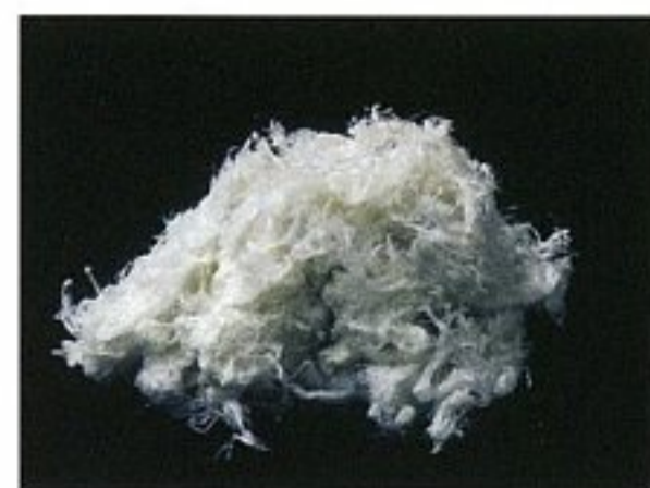
白石綿(クリソタイル)
