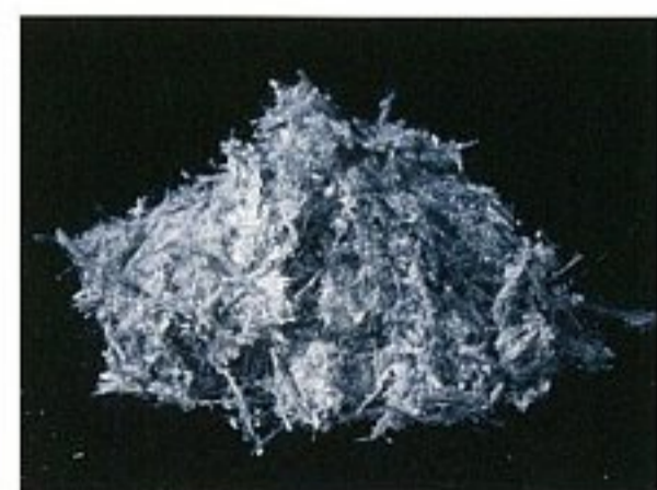
青石綿(クロシドライト)
