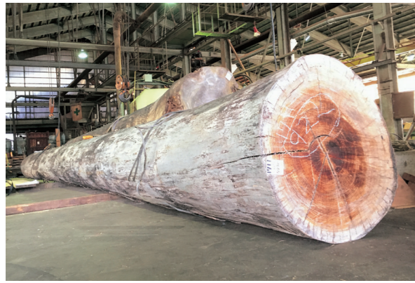
継ぎ目のない冠木は、幹径2桁に及ぶケヤキの大木から製材された。樹齢は130年を超える。
