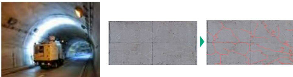
図 4.7 定期点検・詳細調査での新技術イメージ（左：画像計測技術、右：画像診断技術）
