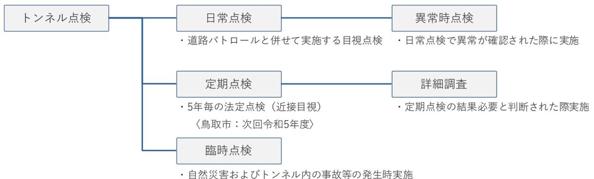
図 3.1 トンネル点検の種類
