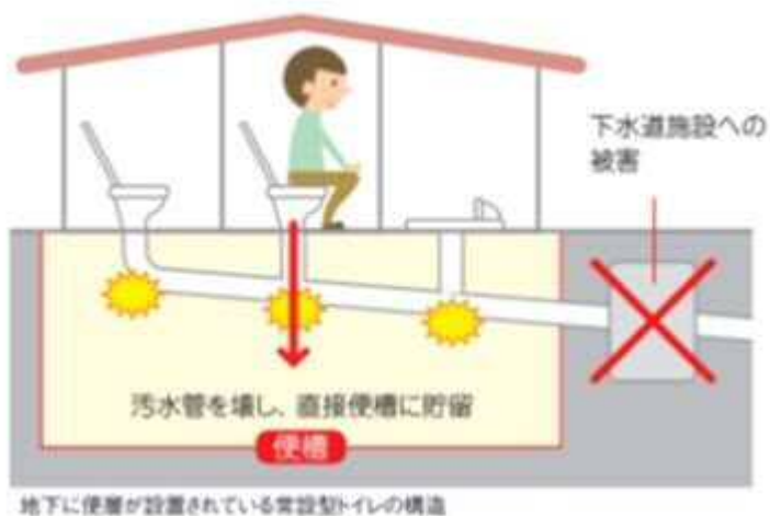
常設型防災トイレ (出典:公益社団法人東京都公園協会)
