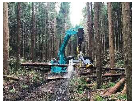
(高性能林業機械ハーベスター)
