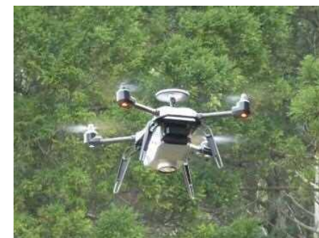
(ドローン等による航空レーザ測量)
