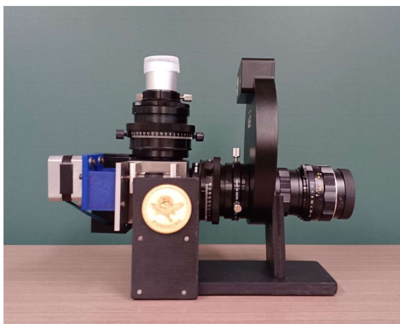
米子高専科学部が製作した分光器 TORIHIME（トリヒメ）
