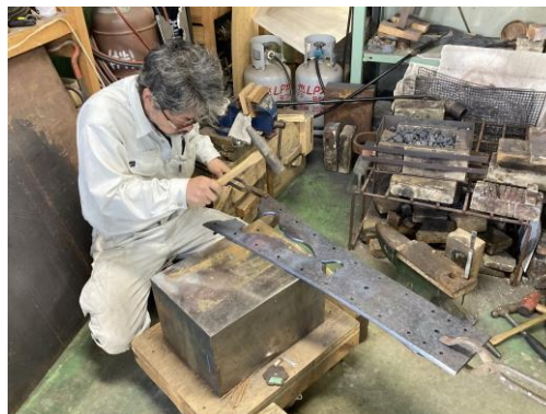
鎚（つち）目打ちの作業風景
